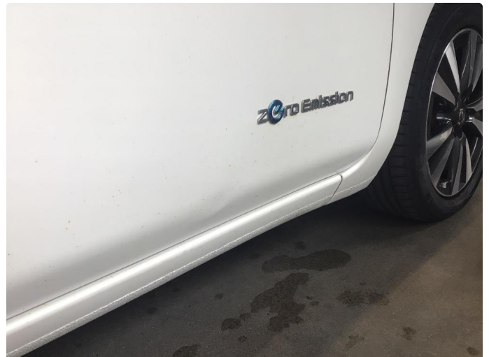
1.1 Parkeringsbulk nedre del høyre fordør
