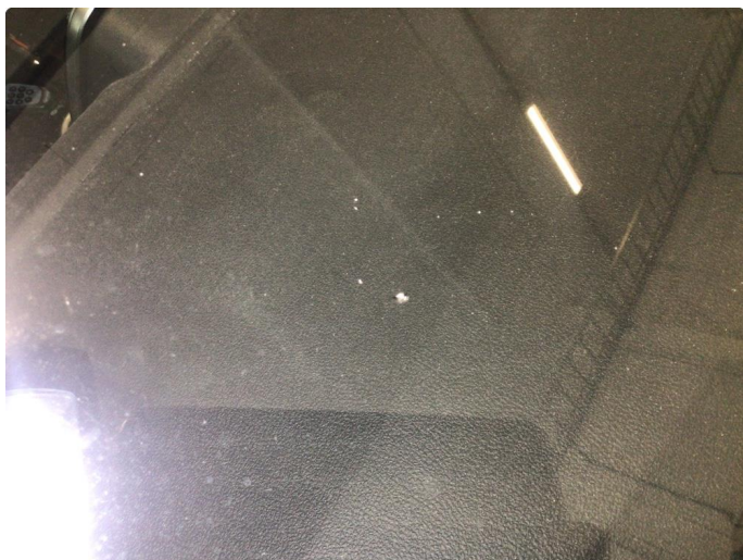
1.4 Noe steinsprut i frontvindu.
