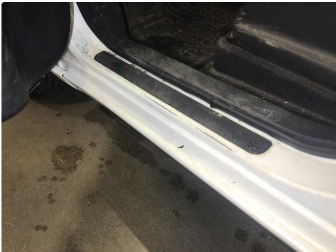
1.2 Slitasje i innsteg dører
