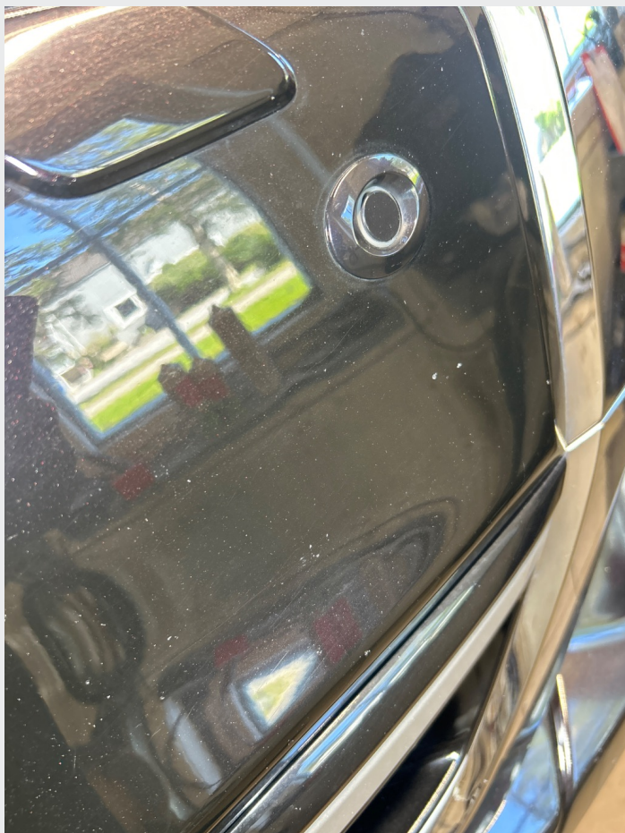
2.1 Noe riper og steinsprut rundt om
