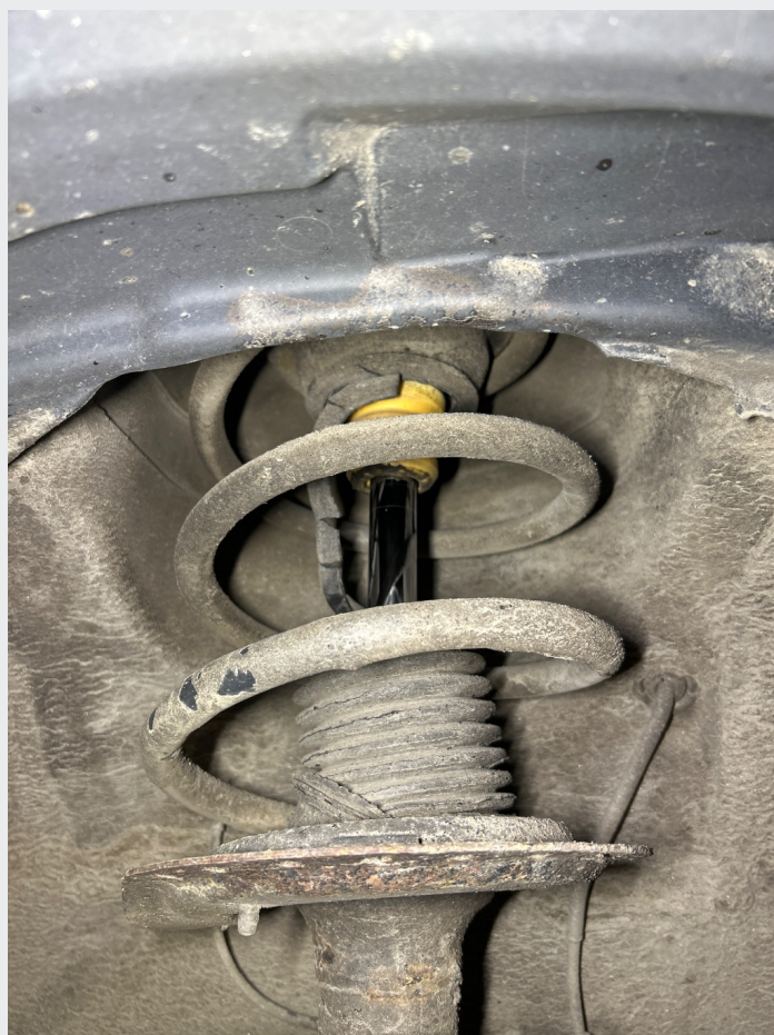
8.6 Revnet mansjett på begge støtdempere foran
