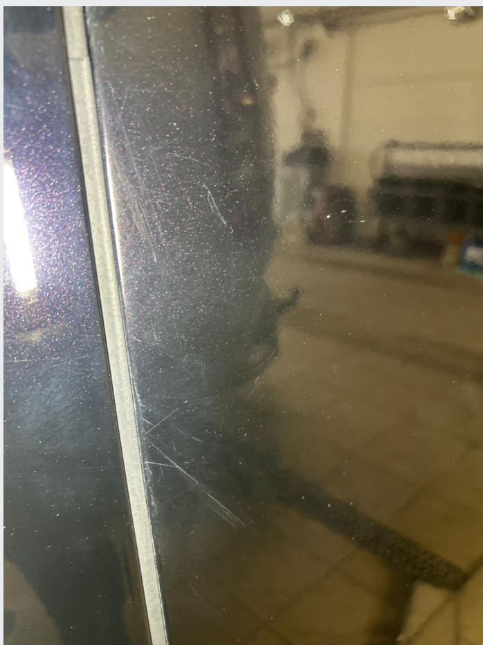
2.1 Noe riper og steinsprut rundt om
