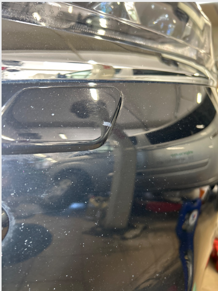
2.1 Noe riper og steinsprut rundt om
