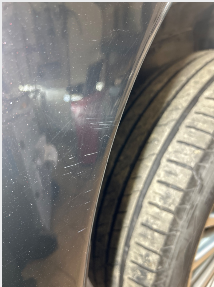
2.1 Noe riper og steinsprut rundt om
