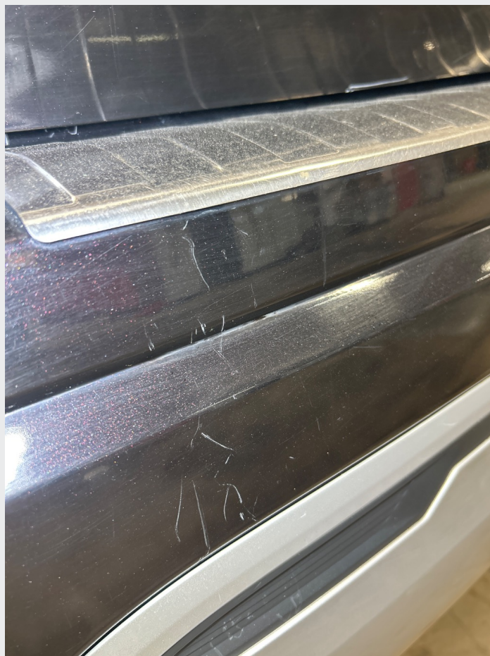
2.1 Noe riper og steinsprut rundt om
