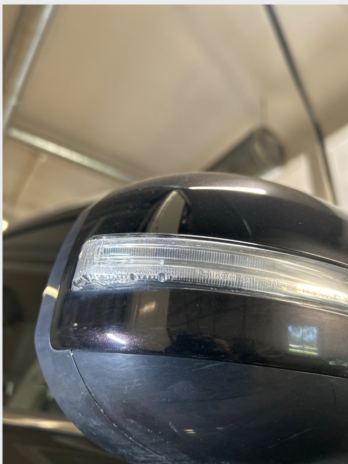
3.4 Litt fukt i blinklykt i høyre speil
