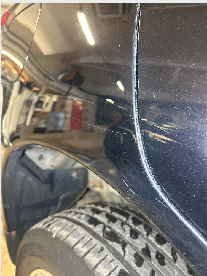
2.1 Noe riper og steinsprut rundt om
