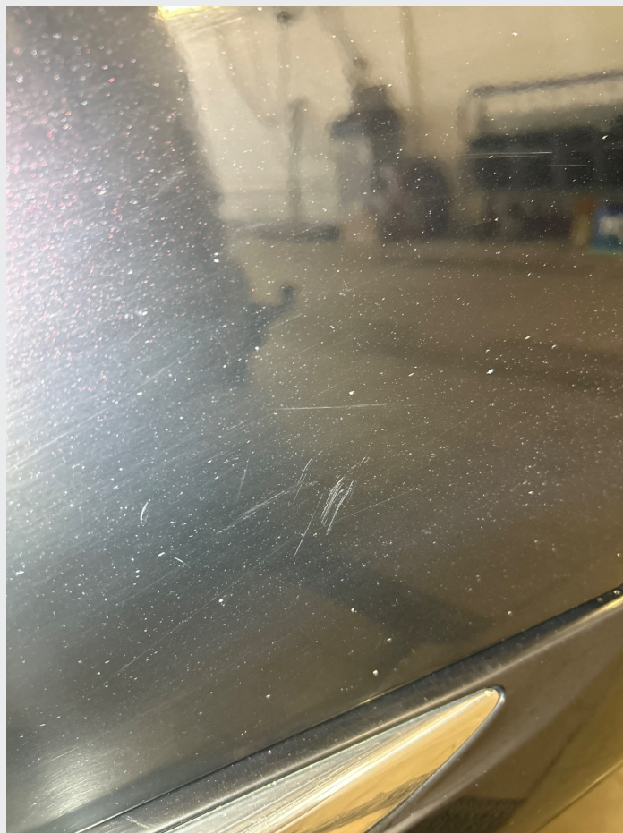
2.1 Noe riper og steinsprut rundt om
