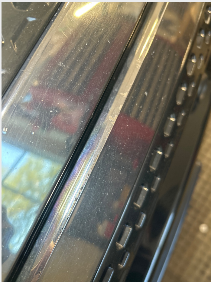
2.1 Noe riper og steinsprut rundt om
