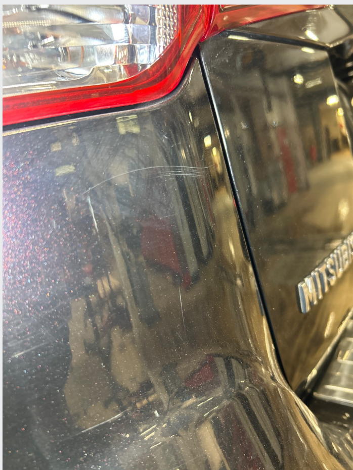
2.1 Noe riper og steinsprut rundt om
