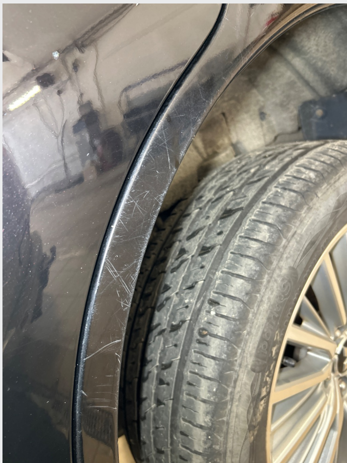
2.1 Noe riper og steinsprut rundt om
