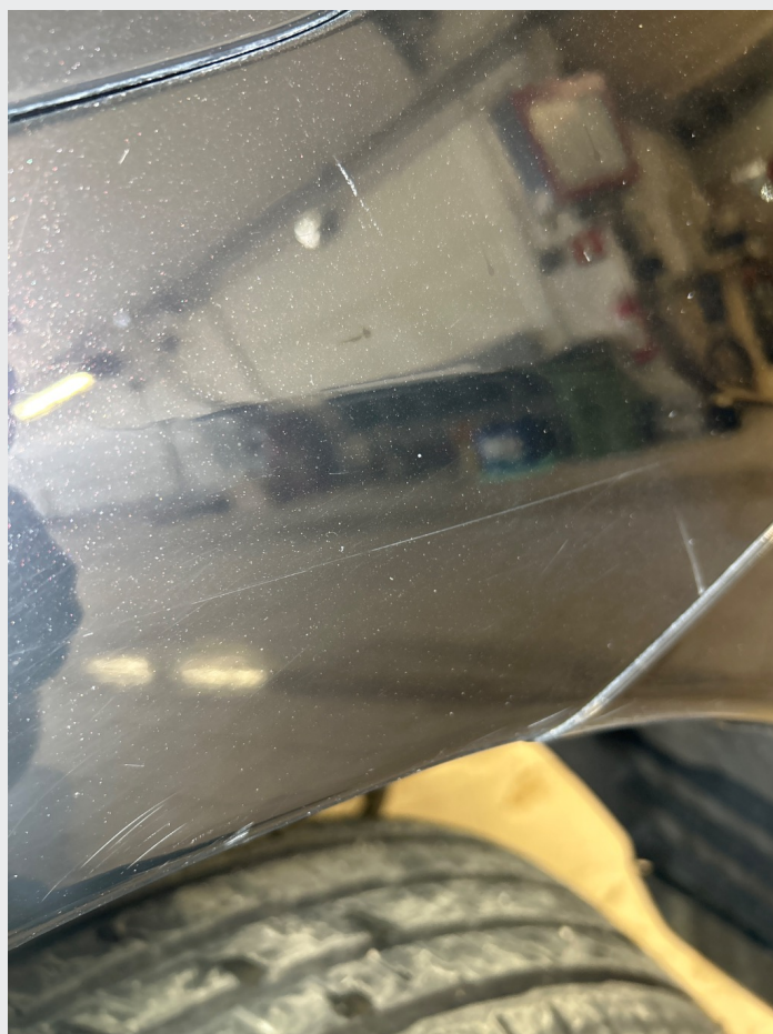
2.1 Noe riper og steinsprut rundt om
