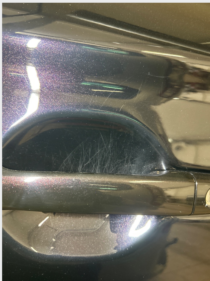
2.1 Noe riper og steinsprut rundt om
