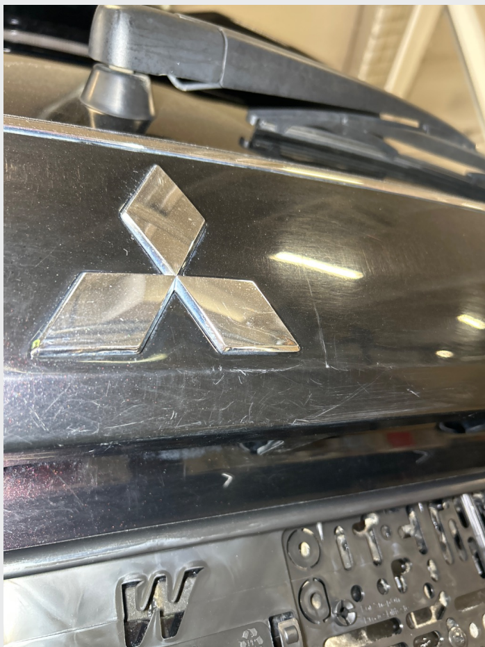
2.1 Noe riper og steinsprut rundt om
