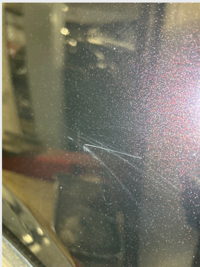
2.1 Noe riper og steinsprut rundt om
