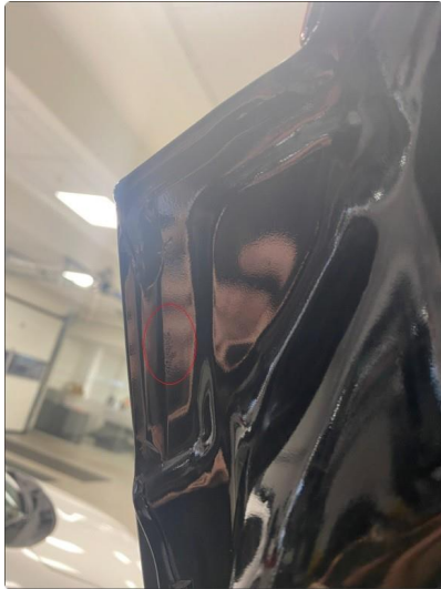
2.1 Fuge ytterst v.side bakluke innside ca 1cm korrosjon under lakk
