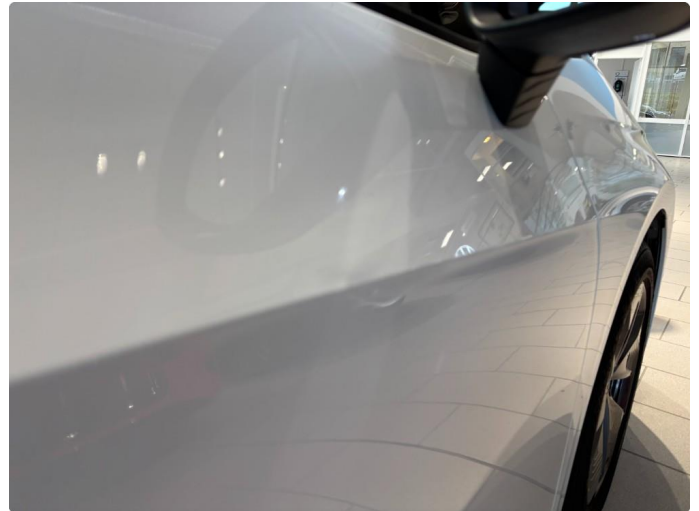
1.2 Vært en P-bulk passasjerdør foran. Den er rettet, syns noe fortsatt
