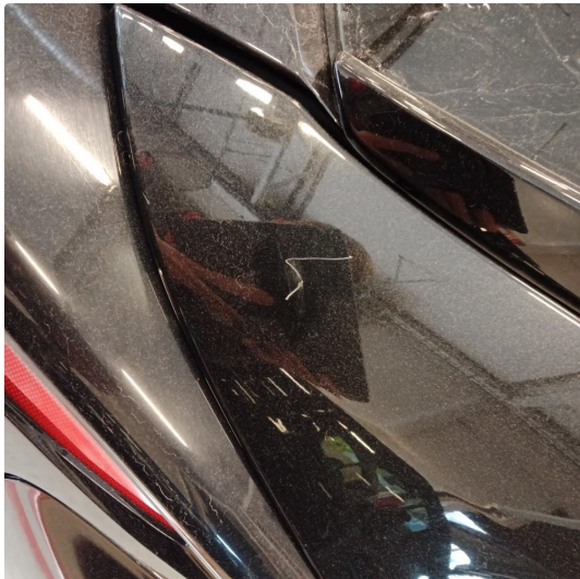
1.1 Riper på bakskjerm. MULIG DEN KAN DEMPES NOE MED RUBBING.
