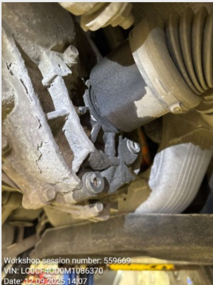
6.3 lekkasje fra bakre differensial
