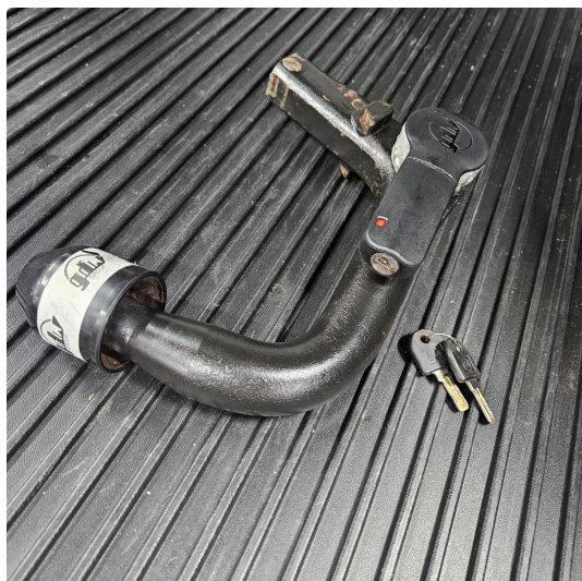
1.1 Defekt låsesylinder/nøkkel på avtagbar krok - funksjon ellers er OK
