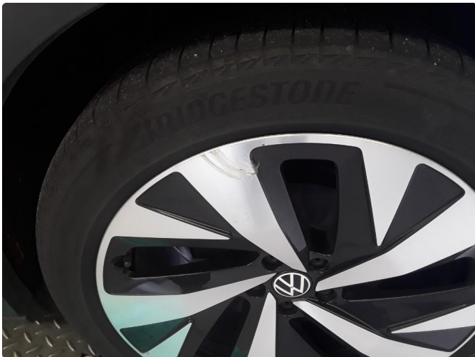
1.1 Kantkjørt felg venstre bak
