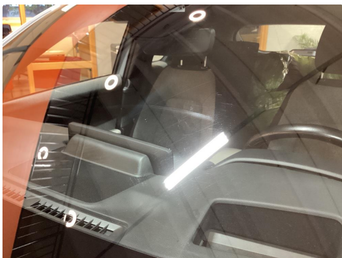
1.2 Slitasje på frontruten , midt på ruten
