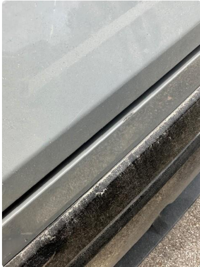
1.1 Ripe bak + en steinsprut på panser
