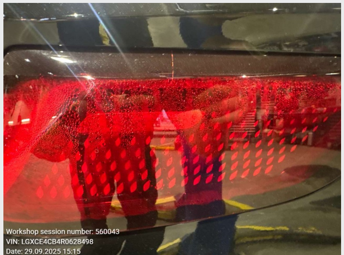
3.2 fukt i høyre baklykt skade i lykt
