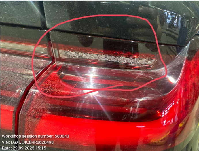
3.2 fukt i høyre baklykt skade i lykt
