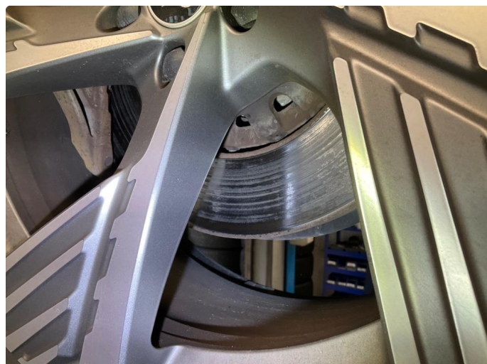
2.1 Overflaterust på utsiden av bremsekiver foran. Bør bruke bremsene mer aktivt
