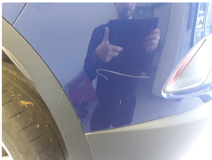
1.4 Ripe støtfanger bak venstre side
