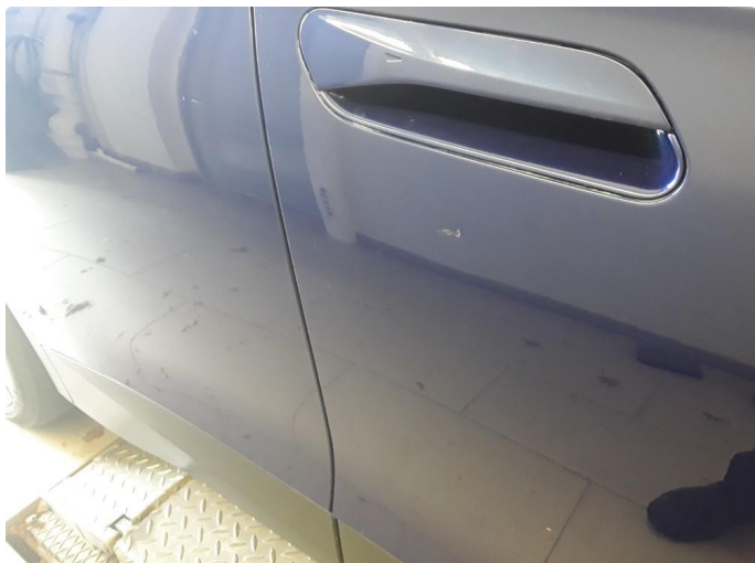
1.1 Liten lakk skade dør h.f under håndtak
