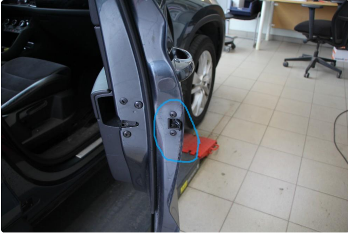
1.2 Dørkantbeskytter mangler på høyre dør foran.
