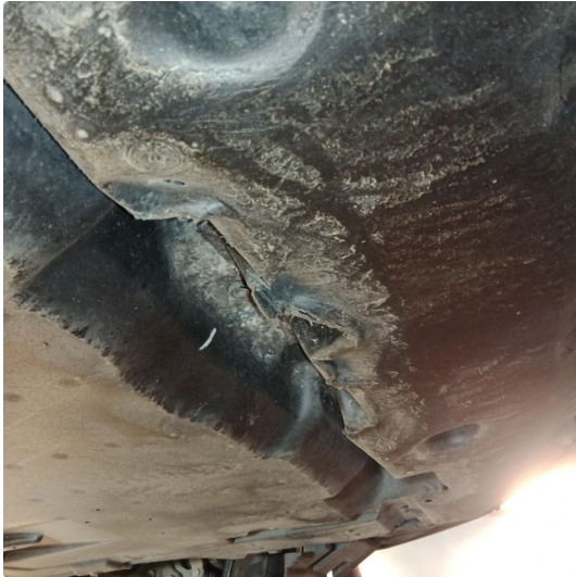
1.1 Fremre deksel under bilen har sprekt og blitt bulket. Usikker om det er mer skader
