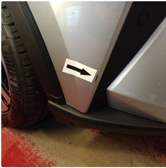
1.5 Begge nedre deksler på side på støtfangeren foran har sprekt. Diverse riper på deksel i midten. Usikker på om det er skader på baksiden på midtre deksel eller i fester. Riper gjennom lakken støtfangeren høyre side foran
