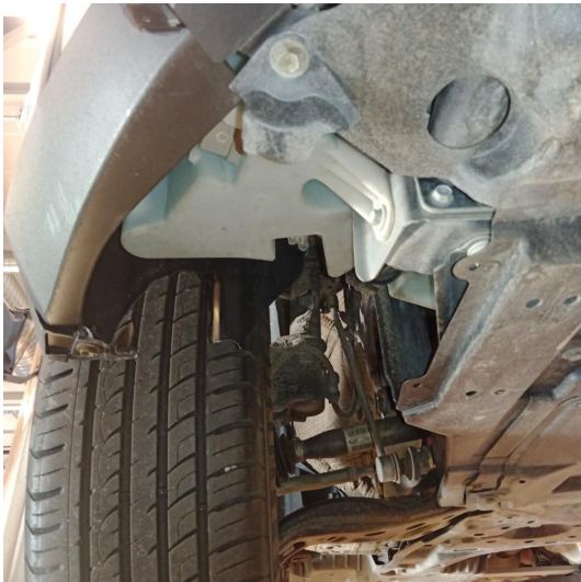
1.3 Mangler deler av innerskjerm høyre side foran og deksel som sitter på undersiden av innerskjermen
