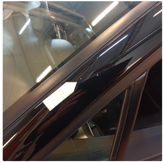
1.6 Små bulker etter steinsprut med lakkskade
