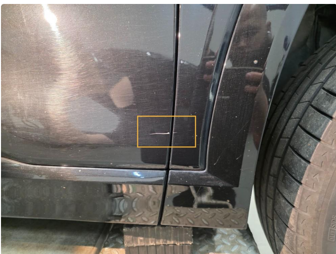
1.2 Ripe ned til grunning
