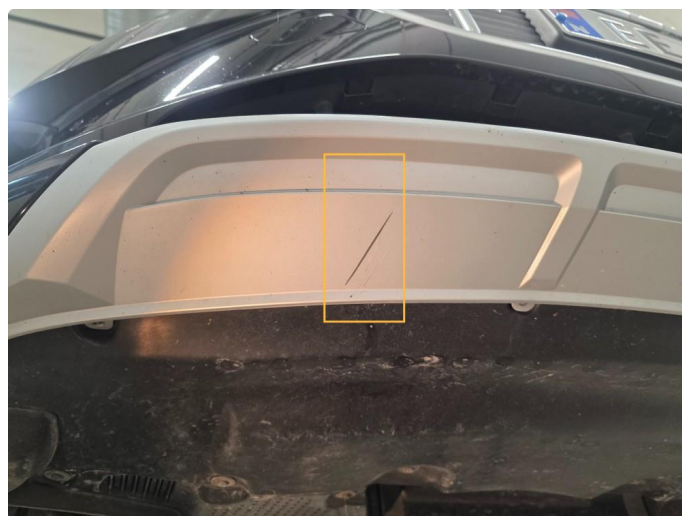
1.5 Ripe(r) ned til grunning
