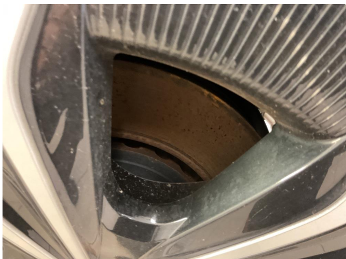
1.1 Noe over flate rust på skiver
