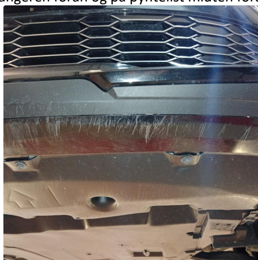
1.2 Unormalt mye riper på undersiden av støtfangeren foran og på pyntelist midten foran
