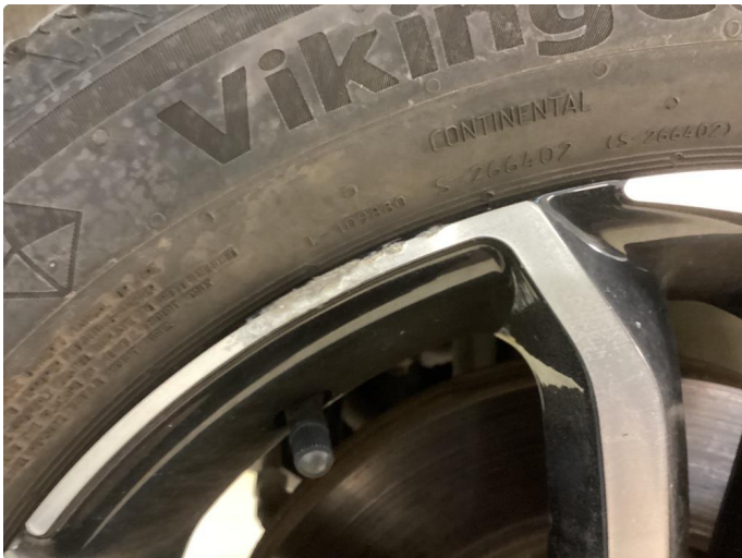
1.1 Skade på felg
