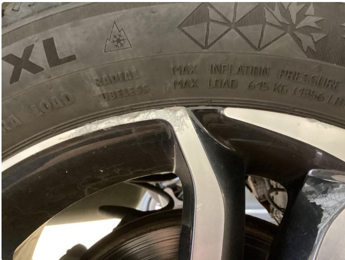
1.1 Skade på felg
