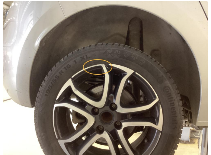
1.1 Skade på felg
