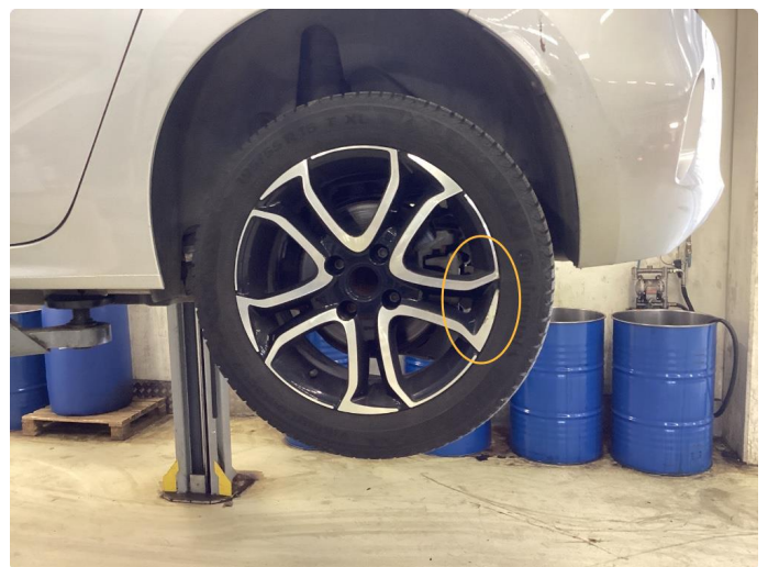
1.1 Skade på felg
