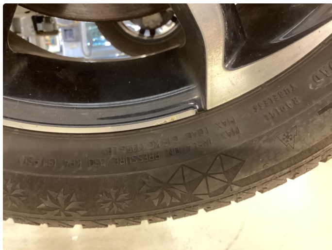
1.1 Skade på felg
