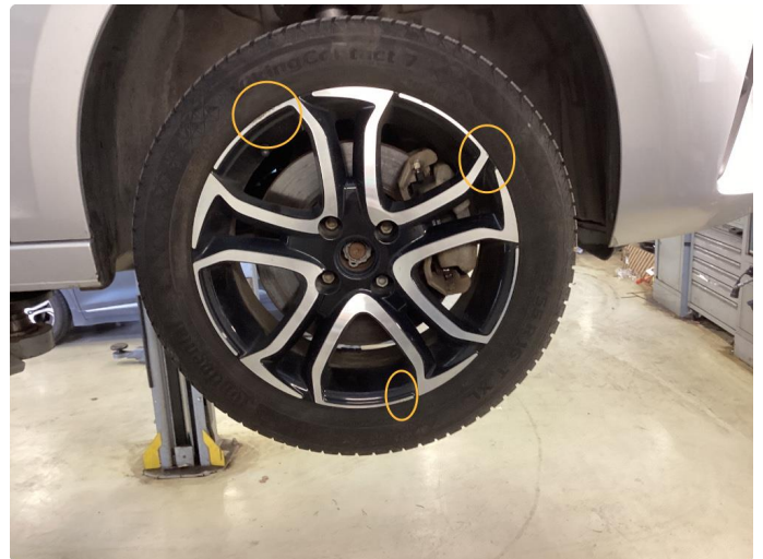
1.1 Skade på felg
