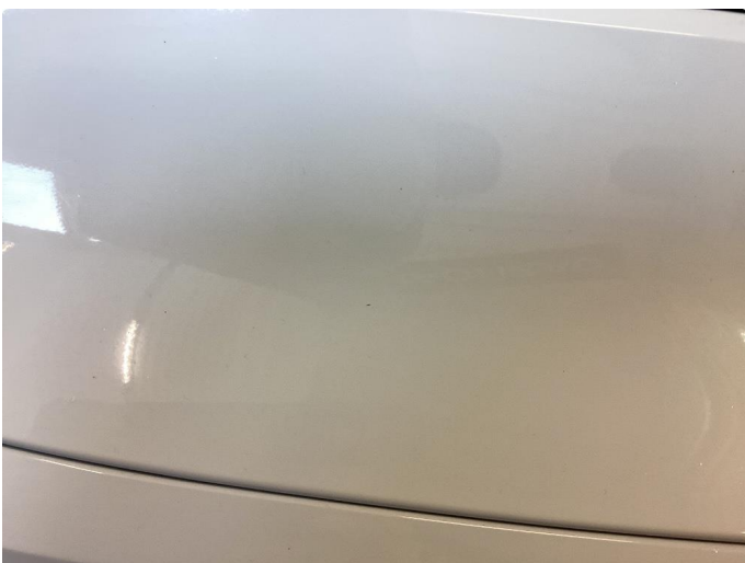
1.4 Noen små steinsprang
