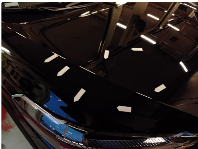
1.1 Unormalt mye steinsprut.18000kr.
