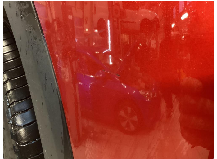
1.2 Ripe(r) ned til grunning
