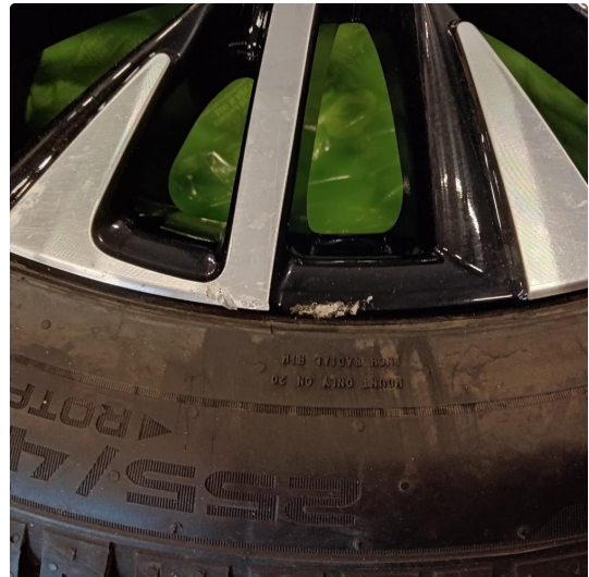
2.2 Kantkjørt felg. Vurderes som normal bruksslitasje.
