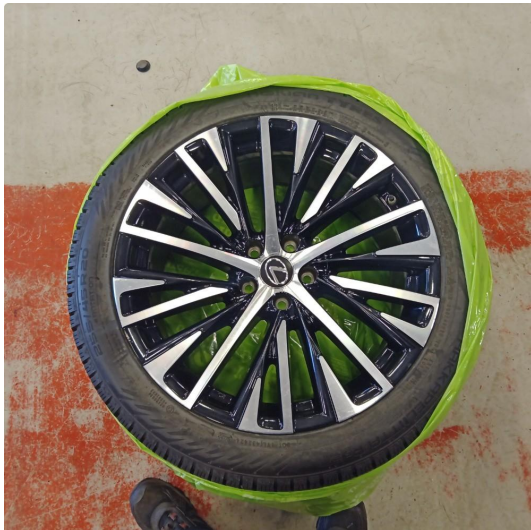
2.2 Kantkjørt felg. Vurderes som normal bruksslitasje.
