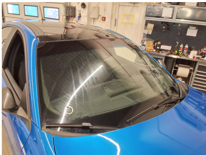
1.9 Steinsprut med sprekk utenfor synsfelt
