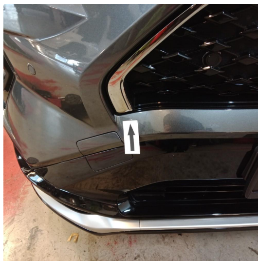
1.2 Liten bulk i støtfangeren foran høyre side. Plastikk Foran under grillen buler støtfangeren litt ut
