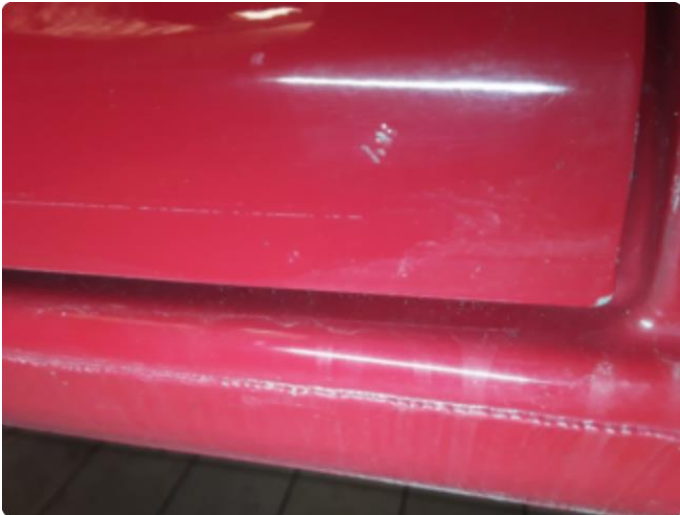
1.1 Div. lakkriper, steinsprut med korrosjon og småbulker.
