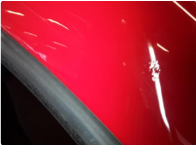
1.1 Div. lakkriper, steinsprut med korrosjon og småbulker.
