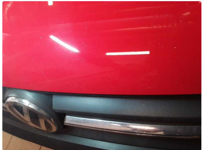
1.2 Liten bulk og steinsprut med korrosjon.
