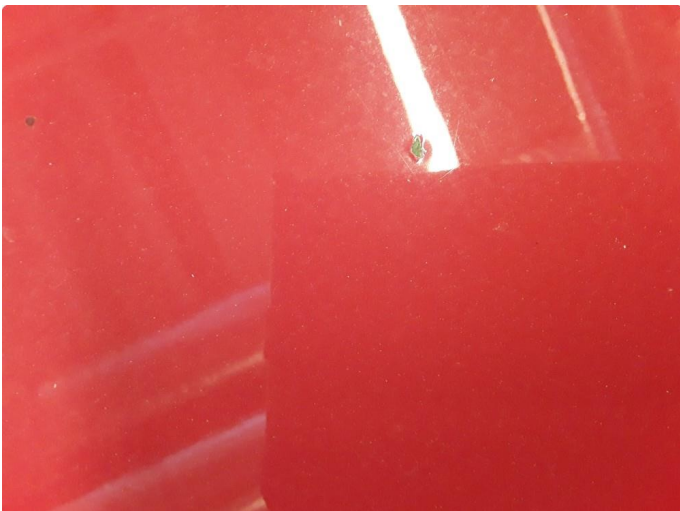
1.2 Liten bulk og steinsprut med korrosjon.
