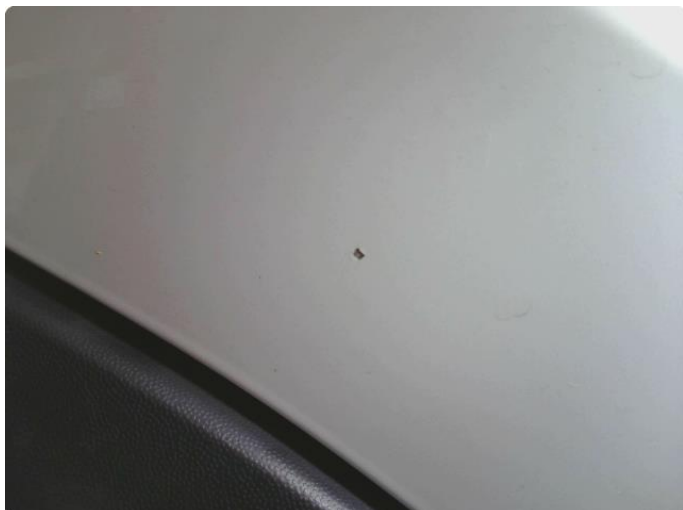
1.3 Steinsprut med rust
