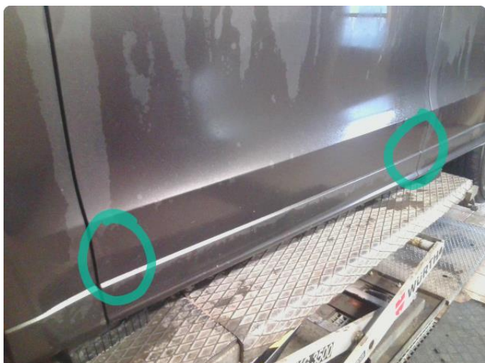
1.1 Steinsprut med korrosjon
