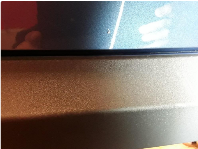
1.3 Steinsprut med korrosjon.
