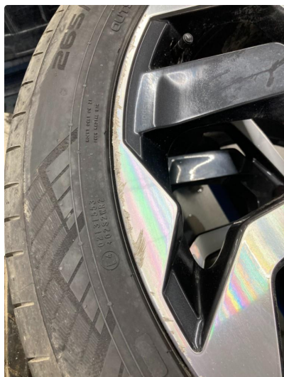
1.1 3 sommerfelger er noe kantkjørt i ytterkant av felg. (Notert)
