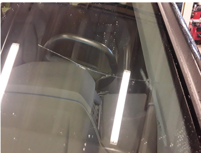
1.5 Steinsprut med sprekk
