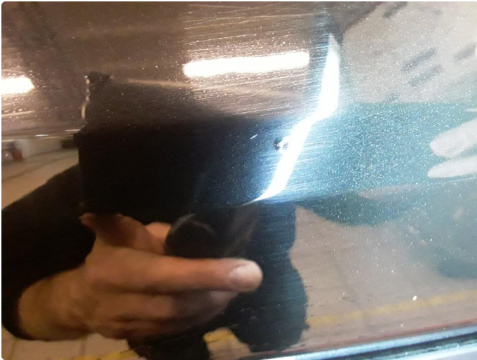
1.2 Steinsprut med rust
