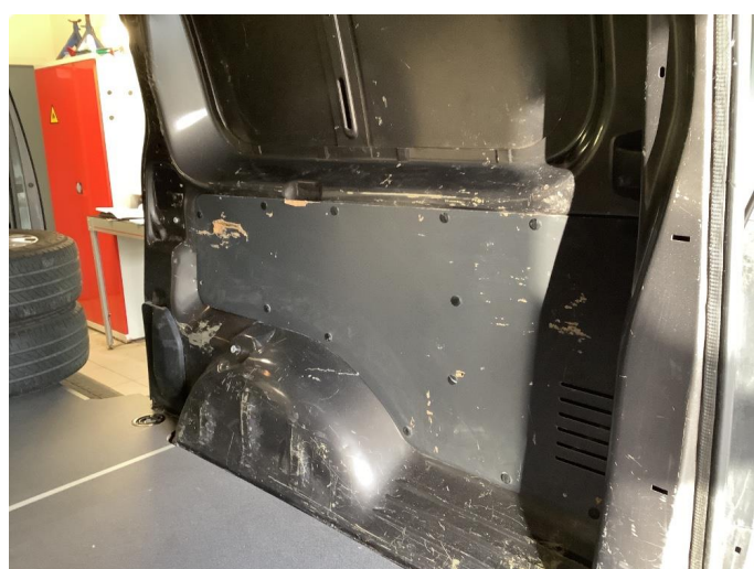
2.1 Div Riper / Små Skader i Vare Rom
