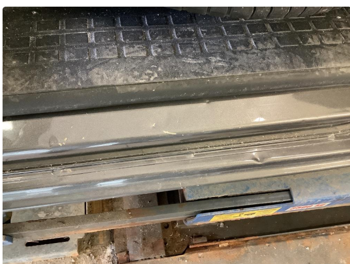
1.2 Noen riper og småbulker I Dør Åpning
