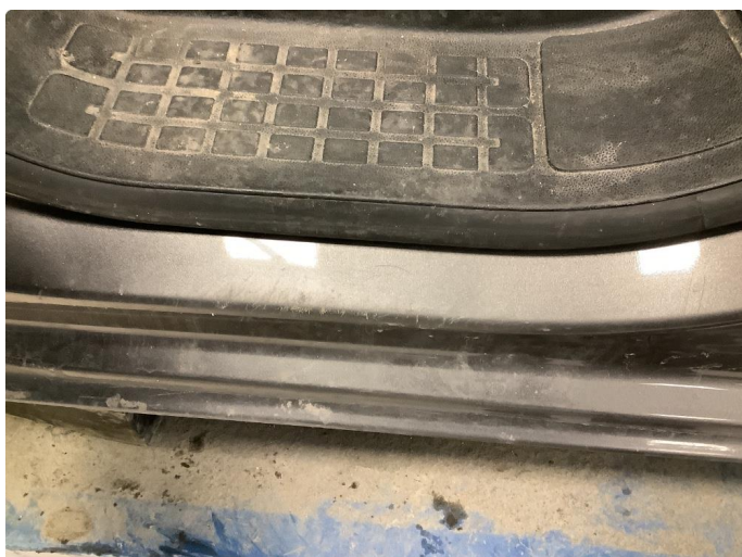
1.2 Noen riper og småbulker I Dør Åpning
