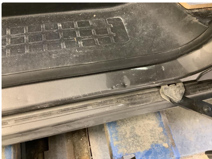
1.2 Noen riper og småbulker I Dør Åpning
