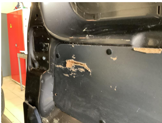
2.1 Div Riper / Små Skader i Vare Rom
