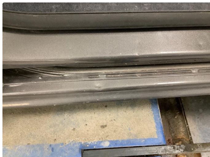
1.2 Noen riper og småbulker I Dør Åpning
