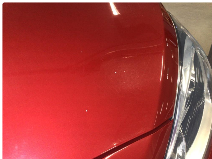
1.1 Noe steinsprut panser
