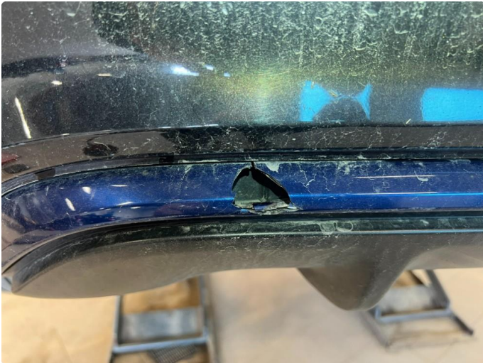
1.2 Skade/ List byttes
