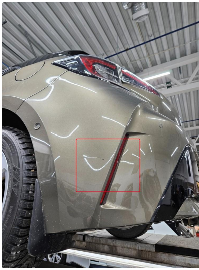
1.3 Liten bulk/ripe i plast-støtfanger bak, nede på v.side, anmerket
