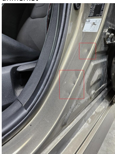
1.2 Noen småbulker på v.side foran og h.side bak, anmerket
