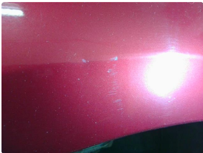
2.10 Bulk med lakkskade
