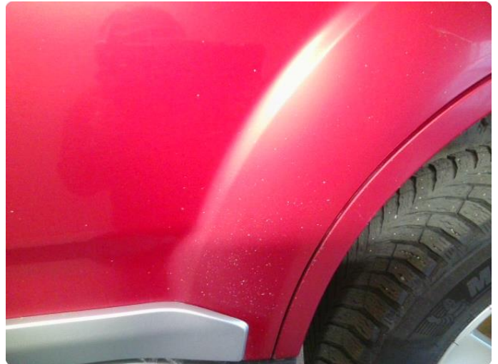
2.3 Steinsprut med rust
