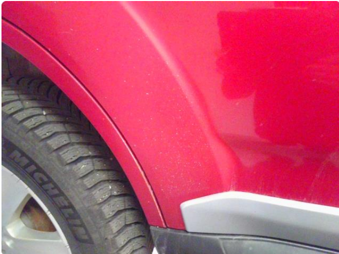
2.4 Flere steinsprut med rust og bulk
