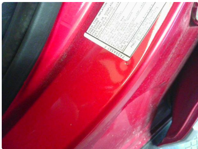
2.11 Bulk med lakkskade
