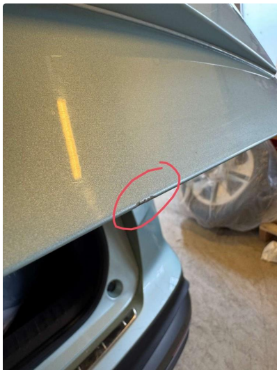
2.1 Rust/korrosjon, blir utbedret før salg
