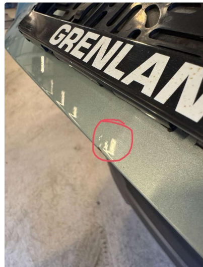
2.1 Rust/korrosjon, blir utbedret før salg
