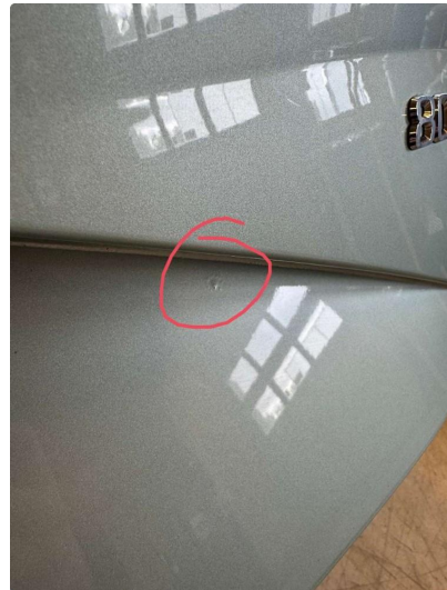
2.1 Rust/korrosjon, blir utbedret før salg
