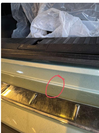
2.2 Noen riper og småbulker
