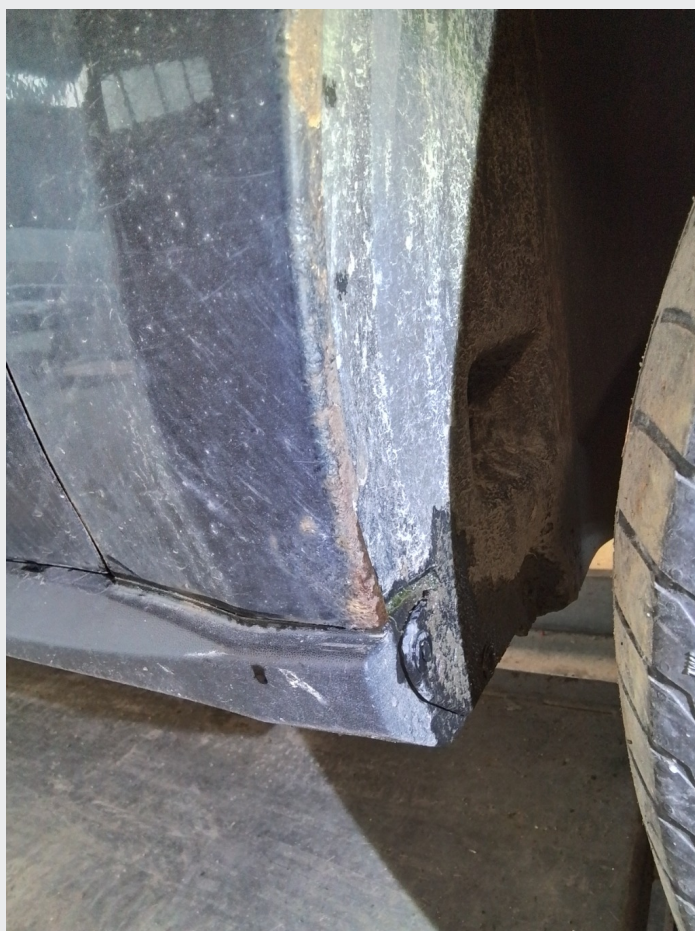
2.7 Rust hjulbuer bs foran
