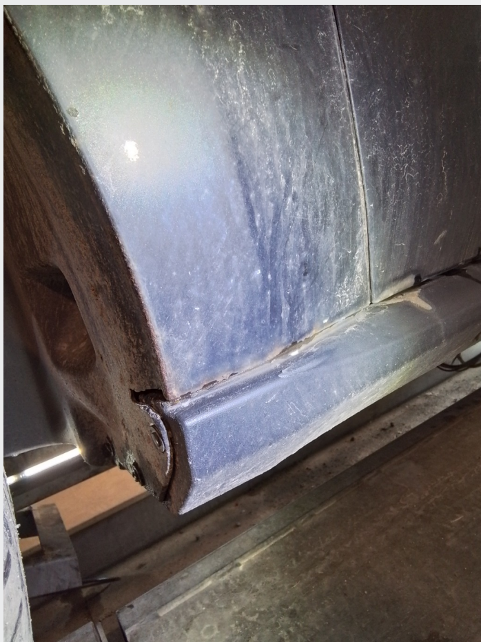
2.7 Rust hjulbuer bs foran
