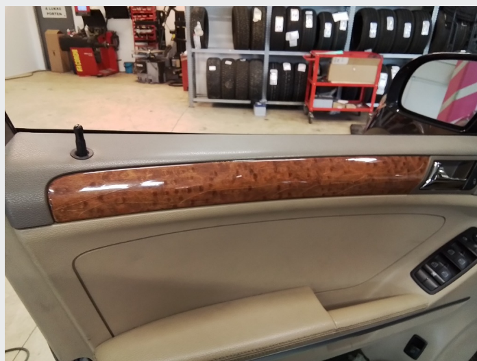
4.4 Spreker i list på dørtrekk førerdør
