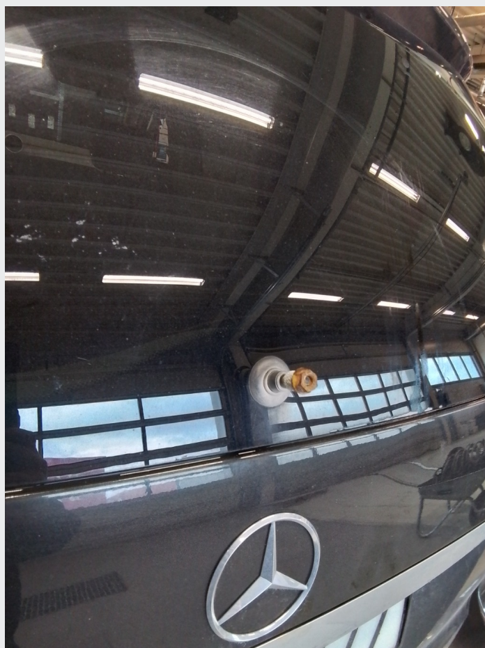
2.16 Visker og viskerarm mangler bakrute
