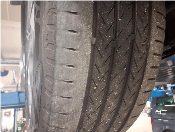
1.1 Skjev slitasje på sommerdekk
