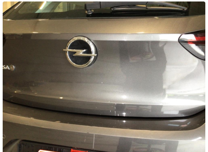
1.2 Noen overfladiske riper på bakluke
