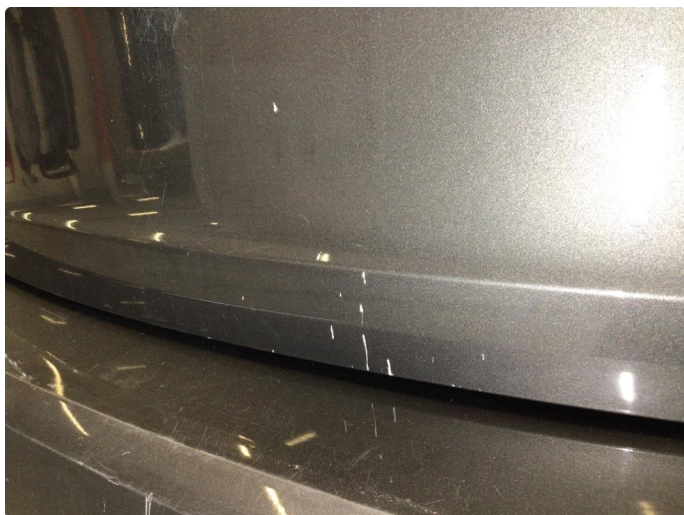
1.2 Noen overfladiske riper på bakluke
