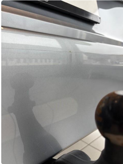
1.1 Noen riper i lakk støtfanger bak. ikke gjennom lakk
