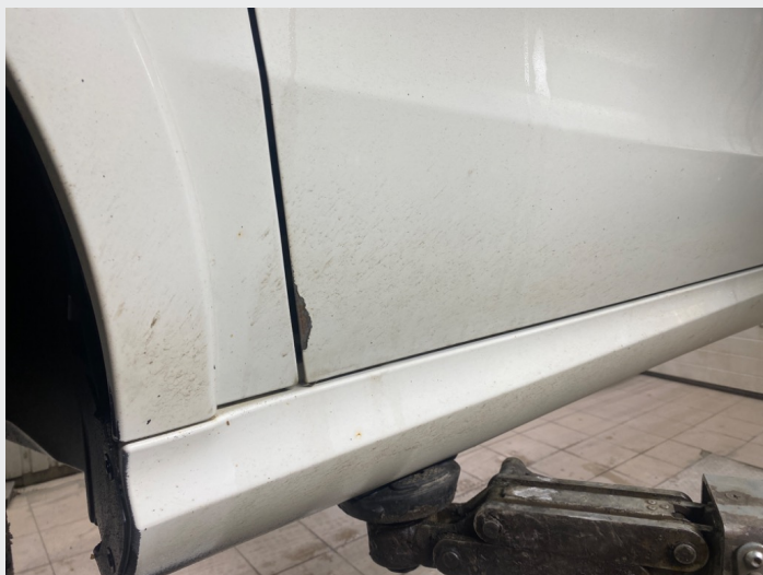
2.5 Rust dør venstre foran
