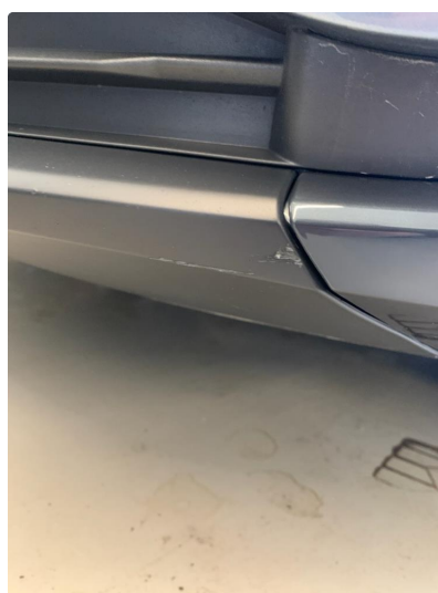
1.4 Noe riper nedre del foran.
