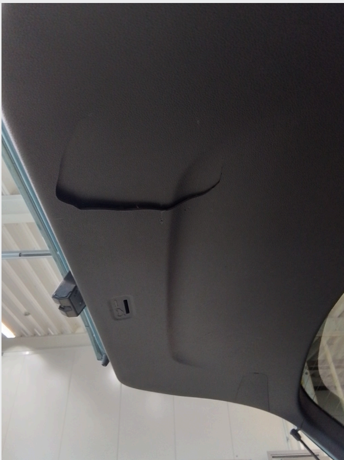
4.4 Hull/sprekk i bakluketrekk
