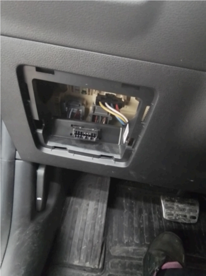
4.7 Deksel over obd kontakt mangler
