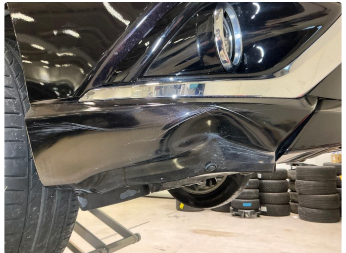
1.4 Høyre fangerhjørne foran -bulk med lakkskade
