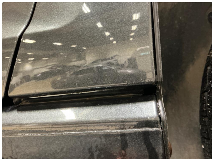
1.8 Høyre forskjerm , rust
