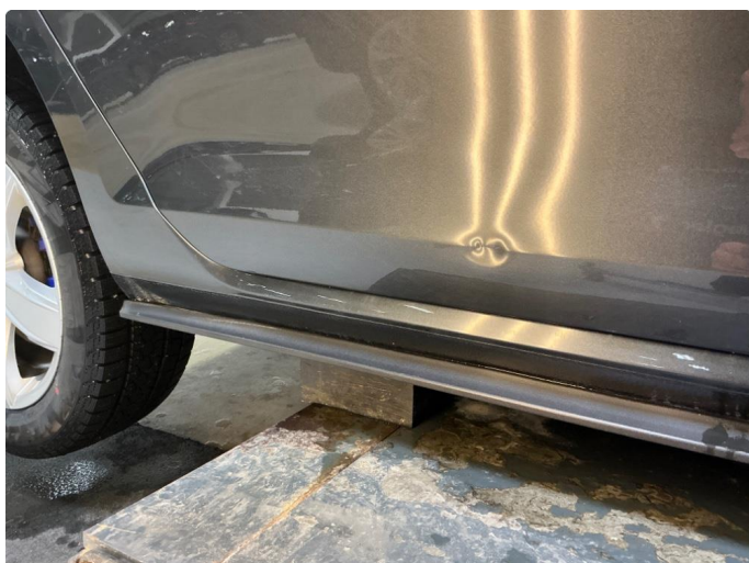
1.4 Høyre bakdør ,bulk
