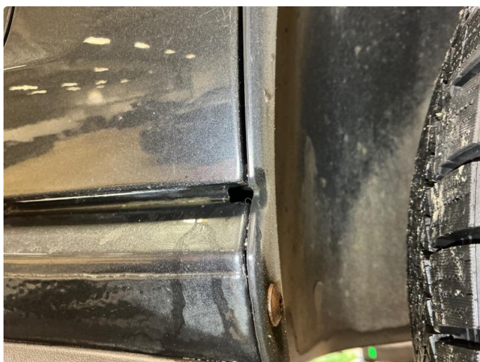
1.8 Høyre forskjerm , rust
