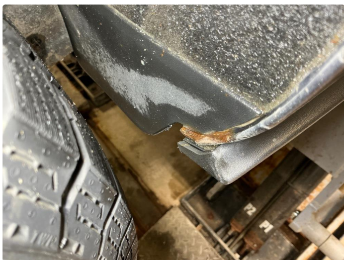
1.10 Høyre bakskjerm, rust
