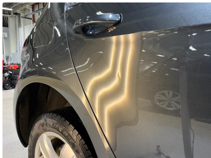
1.3 Høyre bakdør, bulk
