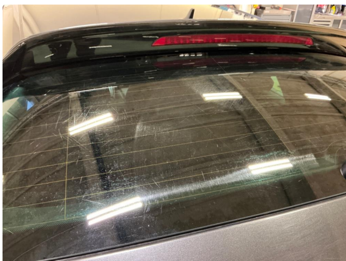
1.16 Mekanisk slitasje bakvindu .
