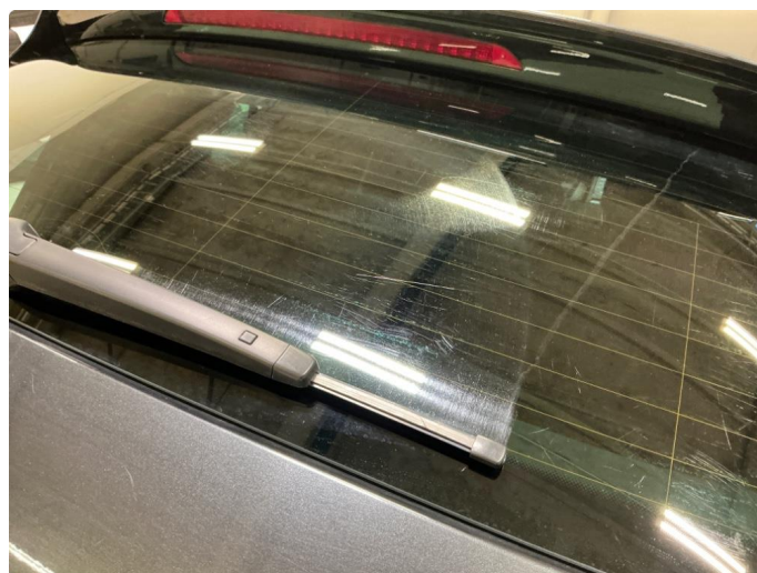
1.16 Mekanisk slitasje bakvindu .
