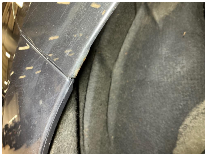
1.10 Høyre bakskjerm, rust
