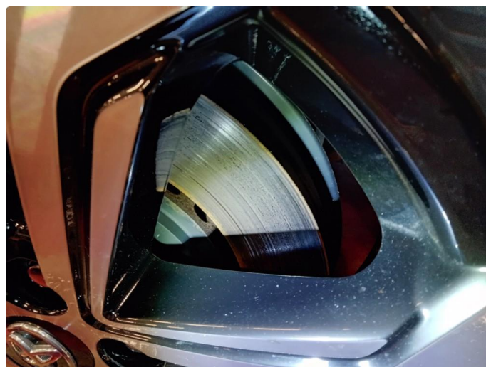
2.1 Noe overflaterust på skiver(kan bremses bort)
