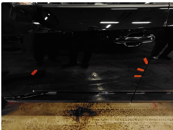
1.11 Div riper og åpningsskader
