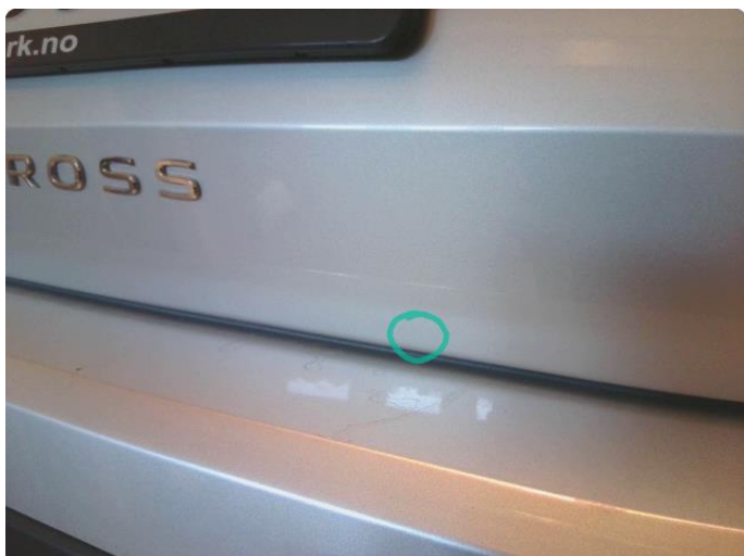
1.1 Steinsprut med rust
