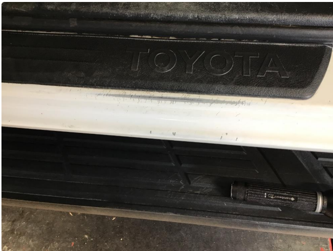
1.3 Slitt gjennom lakk
