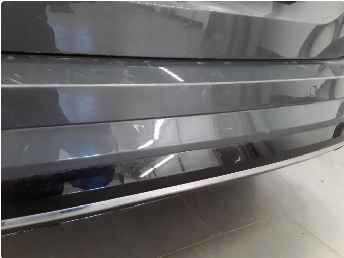
1.2 Noe innlastningsriper støtfanger bak. Normal bruksslitasje
