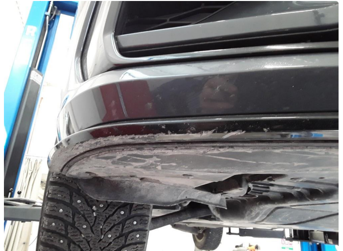
1.3 Noe skrubbskader underkant støtfanger foran. Normal bruksslitasje
